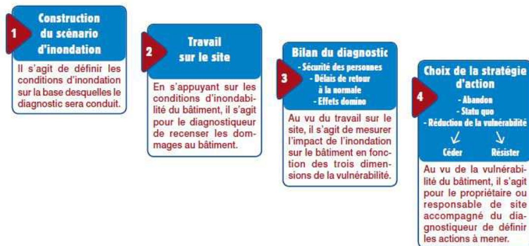
Figure 4-7 Etapes de réalisation du diagnostic [CEPRI, 2010]
