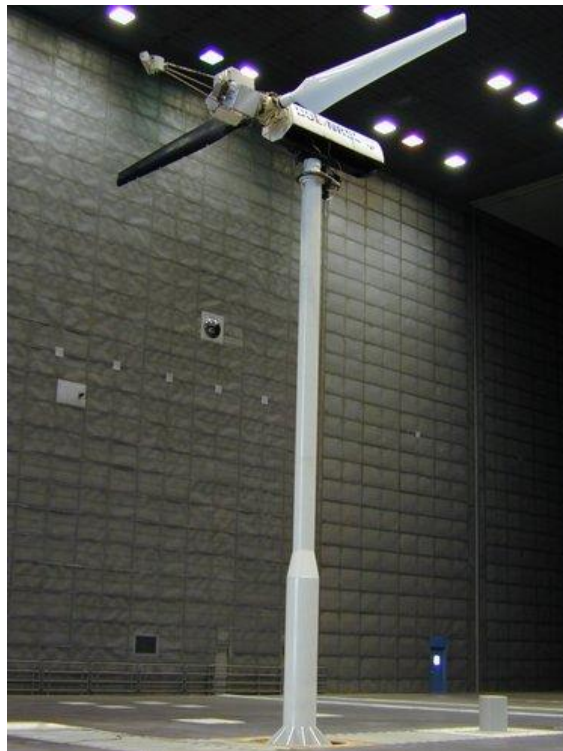
Fig.3.12 Eolienne NREL Phase VI dans la soufflerie de la NASA à Ames [76]
