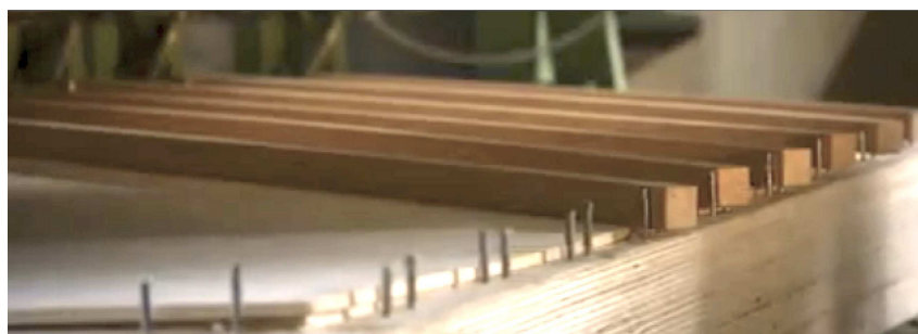
(b) Table d'harmonie d'un piano à queue à laquelle on colle ses raidisseurs non encore taillés. Extrait de www.fazioli.com .
