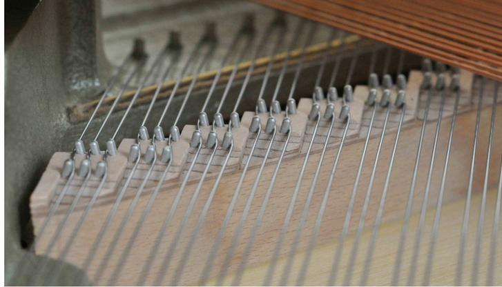
FIGURE I.21 – Configuration d'attache des cordes au chevalet, qui crée une disymétrie entre les deux polarisations (verticale et horizontale) des cordes.
