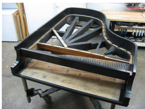
FIGURE I.58 – Structure du piano : plateau de touche, ceintures et barrage. Extrait de www.saintpiano.com
