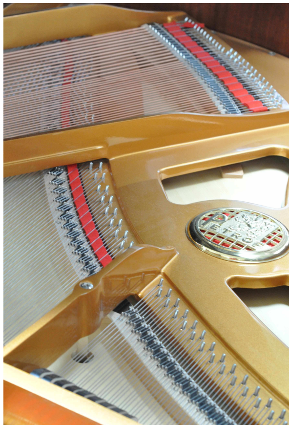
FIGURE I.1 – Cordes d'un piano à queue en situation de jeu. Les cordes aiguës sont en premier plan (on voit ici la partie des cordes reliée au chevalet), les cordes graves en second plan sont croisées et passent au dessus pour aller rejoindre le chevalet des graves.
