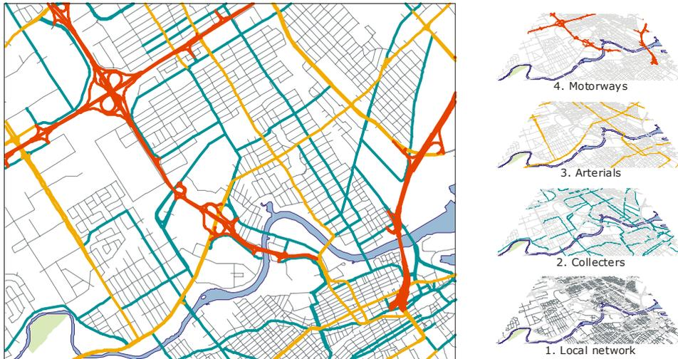
FIGURE 3.3.: Hiérarchie d'un réseau. *Source* : ECMT (2007)
