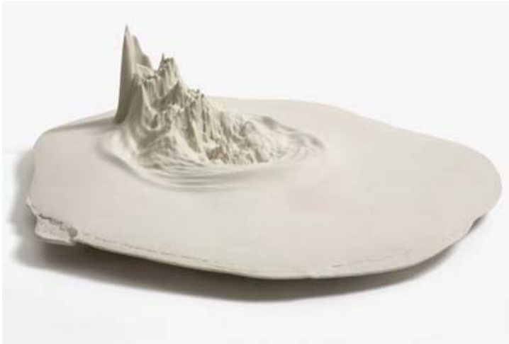
# 12 : expérimentation de mise en forme de céramique à partir de l'utilisation d'un outil de conception et de modélisation 3D et d'une imprimante 3D [Hansen, 2009].
