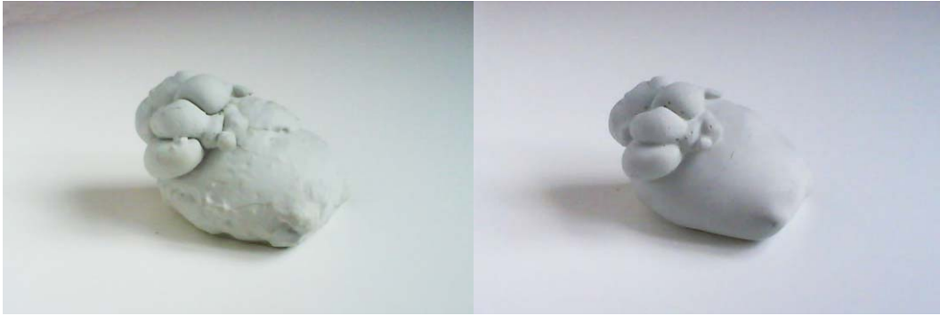
# 61 : Versions initiale avec aspérités (à gauche) et finale sans aspérités (à droite) d'une cale de porte 'Mouss'
