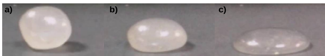
Figure 1 - Un liquide viscoélastique tel que cet échantillon de poly(diméthylsiloxane) (silicone) de grande masse moléculaire se comporte comme un solide aux temps courts et comme un liquide aux temps longs. Les clichés a), b) et c) sont respectivement pris 5 s, 100 s et 1000 s après avoir déposé la boule de polymère.
