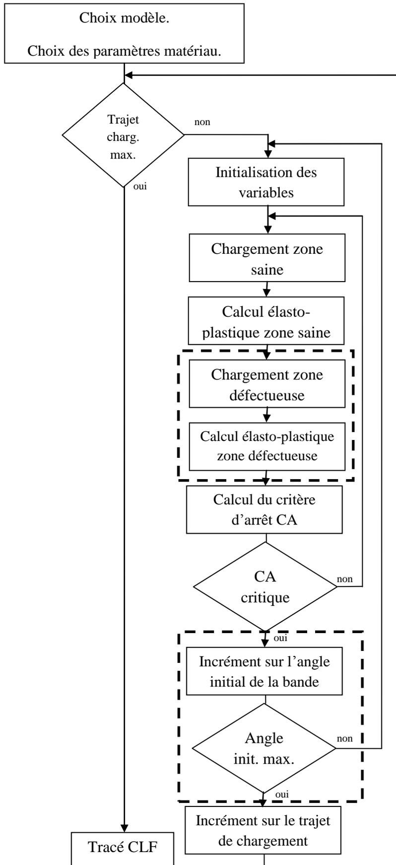
Figure 6.6 : Schéma d'intégration du modèle M – K.
