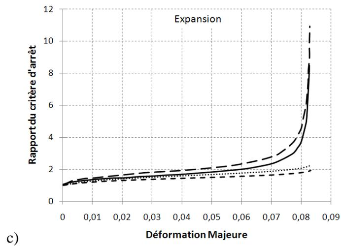
*Figure 6.8* : Exemple d'évolution des rapports des déformations équivalentes, des déformations principales majeures ou de leurs taux dans les zones défectueuses et saines a) en traction uniaxiale, b) en traction plane et c) en expansion.
