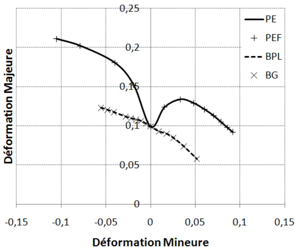
Figure 7.3 : CLF obtenues pour un acier Dual Phase avec les critères de Bifurcation Générale, Bifurcation par Point Limite, Perte d'Ellipticité et Perte d'Ellipticité Forte.
