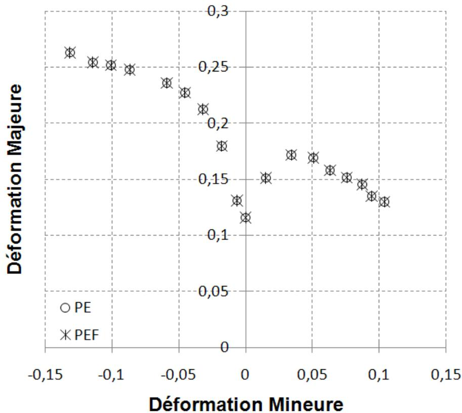
Figure 6.3 : CLF obtenues à partir des critères de Perte d'Ellipticité et de Perte d'Ellipticité Forte pour un acier Dual Phase DP600 modélisé avec une loi d'écroutissage isotrope saturante ( $C_R = 10$ ,  $R_{sat} = 550MPa$  et  $Y_0 = 350MPa$ ) et couplé à l'endommagement ( $\beta_{end} = 12$ ,  $S_{end} = 20$  et  $s_{end} = 0,5$ ) d'après (Altmeyer et al. 2010).
