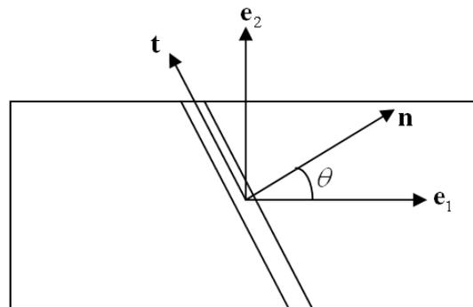
Figure 5.1 : Orientation de la bande de striction localisée par rapport aux directions principales de chargement.
