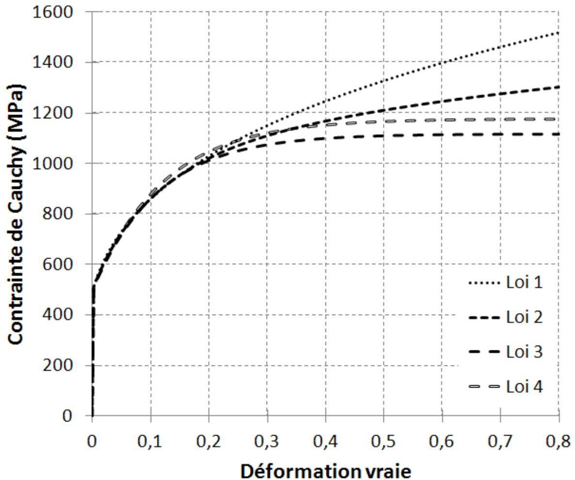
Figure 7.6 : Courbes de comportement en traction uniaxiale de l'acier TRIP B.
