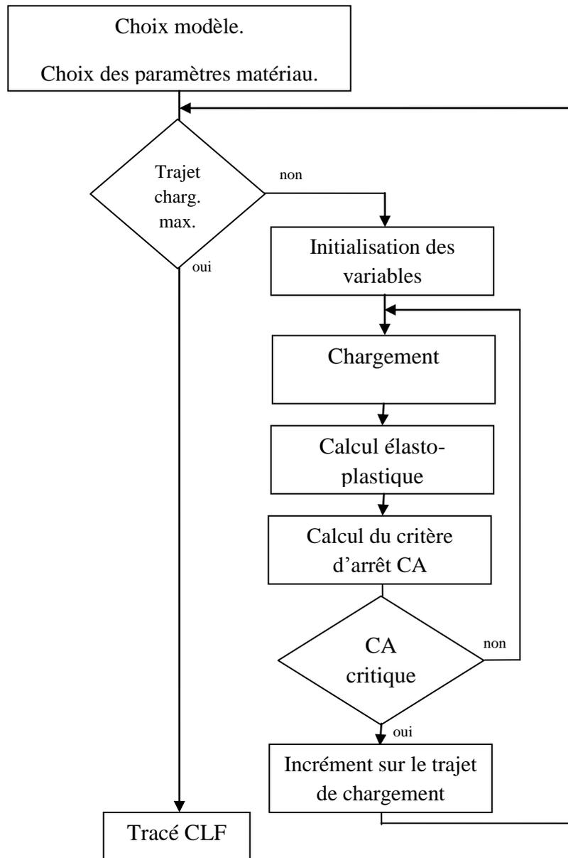
Figure 2.6 : Schéma général d'implantation des critères d'instabilité plastique.
