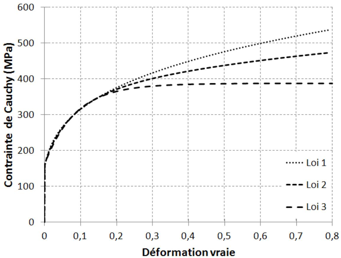
Figure 7.8 : Courbes de comportement en traction uniaxiale de l'acier doux.
