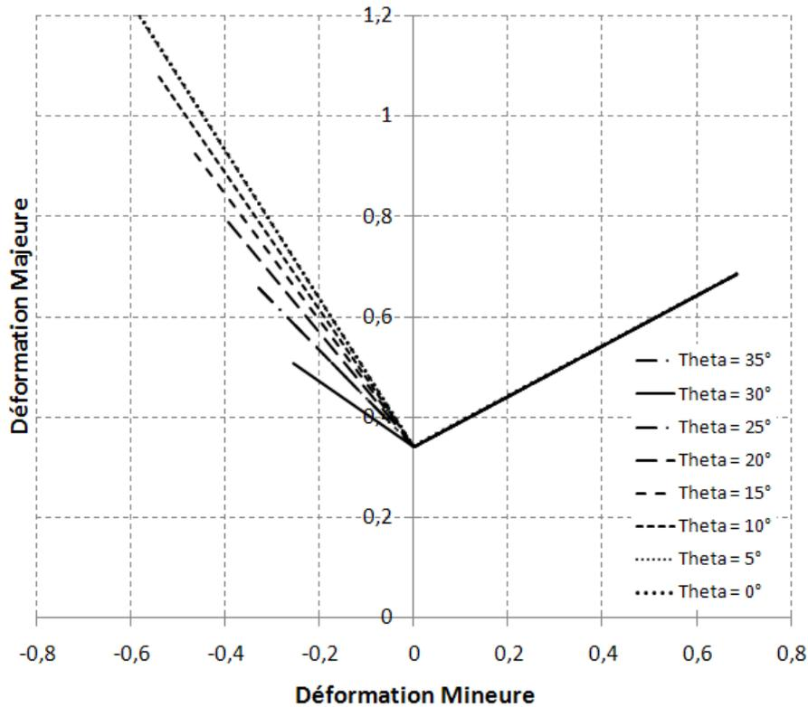
Figure 6.5 : Exemple d'influence de l'orientation initiale de la bande du défaut initial sur les déformations critiques à localisation pour des trajets de traction uniaxiale, de traction plane et de traction équibiaxiale.
