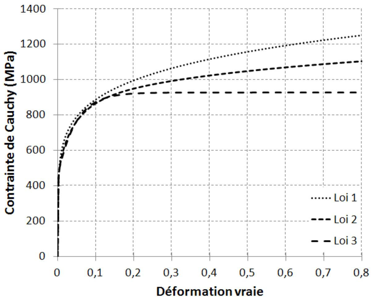
Figure 7.10 : Courbes de comportement en traction uniaxiale de l'acier Dual Phase.
