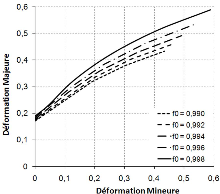
Figure 6.7 : Influence de la valeur du défaut initial sur le tracé de CLF. Application à un matériau fictif à écrouissage isotrope ( $n = 0,2$  et  $k = 580\text{MPa}$ ).
