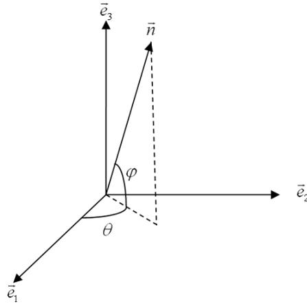
Figure 5.6 : Orientation de la normale au plan de localisation selon le critère d'ALS par rapport aux directions principales de chargement  $\mathbf{e}_1$ ,  $\mathbf{e}_2$  et à la normale au plan de la tôle  $\mathbf{e}_3$ .
