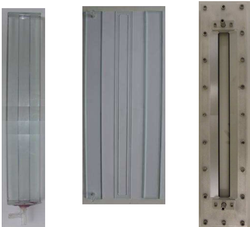
Figure 63 : Évolution de la cellule d'expérimentation. De gauche à droite : premier prototype conçu complètement en verre, complètement fermé, ensuite cellule en verre démontable et finalement cellule démontable en verre insérée dans une armature d'acier inoxydable.
