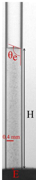
FIGURE I.4.5 – Montée capillaire initiale pour un tube de  $0,4 \text{ mm}$  et une huile de  $0,5 \text{ Pa.s}$
