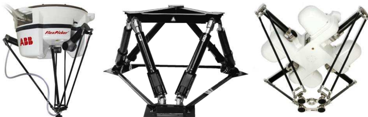
Figure 1 – 9 : Différents systèmes de positionnement en parallèle
