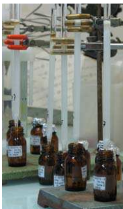
Figure 67 : Dispositif de purification sur colonne de silice
