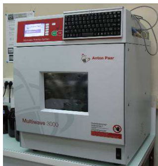
Figure 65 : Système d'extraction par micro-ondes
