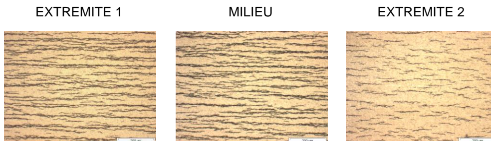
Figure 99 : Révélation des hydrures en microscopie optique (lumière blanche) pour une plaquette hydrurée à 300 ppm H.
