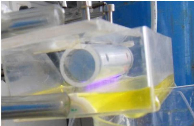
Notre système de circulation du liquide est fermé. En effet, le liquide passe d'un cristalliseur au réacteur grâce à une pompe puis il est soumis à la décharge pour enfin déborder du réacteur et regagner le cristalliseur.
