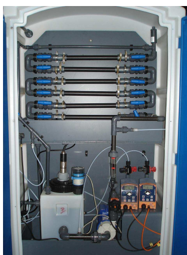
Figure II-14 : Photo d'une boucle du pilote de vieillissement par recirculation d'une solution de chlore ou dioxyde de chlore [GAU09]
