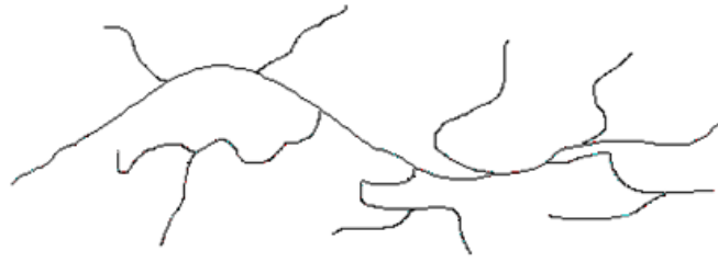
Figure I-13 : Schéma d'une chaîne ramifiée de PEBD
