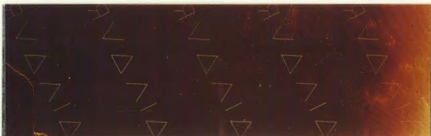
Figure I.14 : Image filtrée d'un réseau binaire obtenu sur une couche uniforme de photorésine négative
