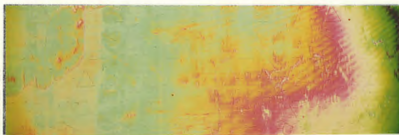
Figure I.13 - Défauts de modulation d'un réseau dus à une non uniformité de la couche sensible
