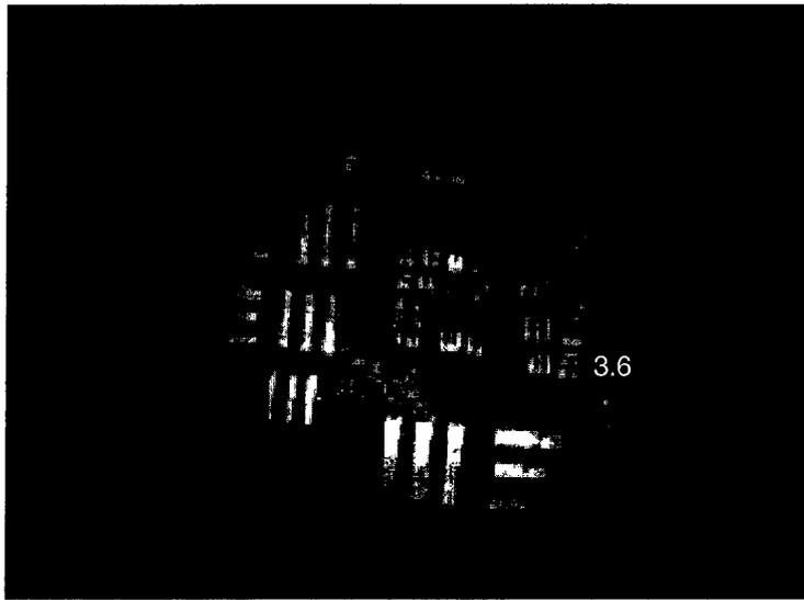
Figure 2.40 : Image de la mire USAF formée avec le faisceau complémentaire.
