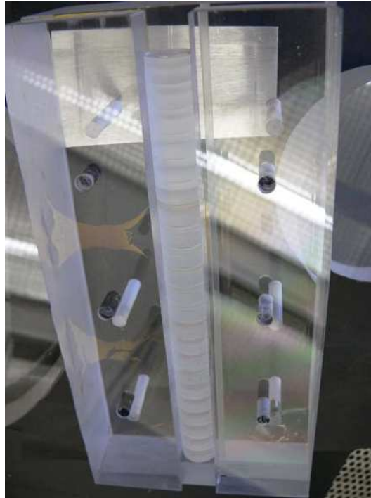
FIGURE 4.12.: Les 22 paires de lentilles mises en place avant collage.
