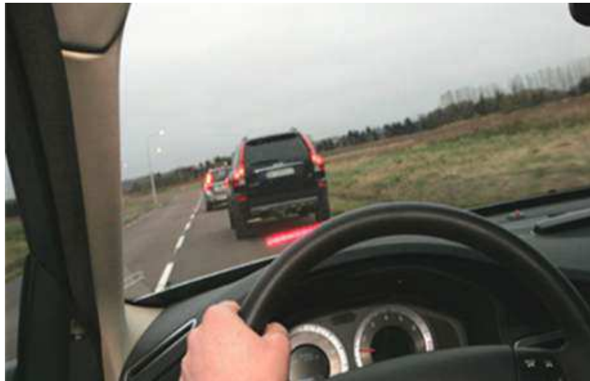
FIGURE 3.2 – Alerte visuelle du Forward Collision Warning proposé par Volvo : une barre de LED s'illumine en rouge pour signaler une distance intervéhiculaire trop courte.
