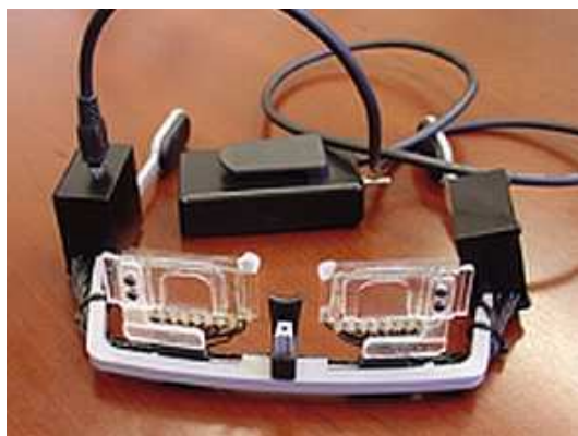
Fig. 1: Prototype de lunette électro-active développé par la société PixelOptics réalisant une mise au point automatique.
