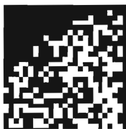
Fig.VI.3 : faisceau du générateur de nombres aléatoires, avant centrage. On remarque la section circulaire du champ de speckle, à l'intérieur de laquelle les étiquettes prennent des valeurs aléatoires.
