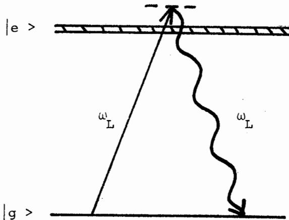
FIGURE 8 : Ordre 1 du développement; diffusion de photons RAYLEIGH
