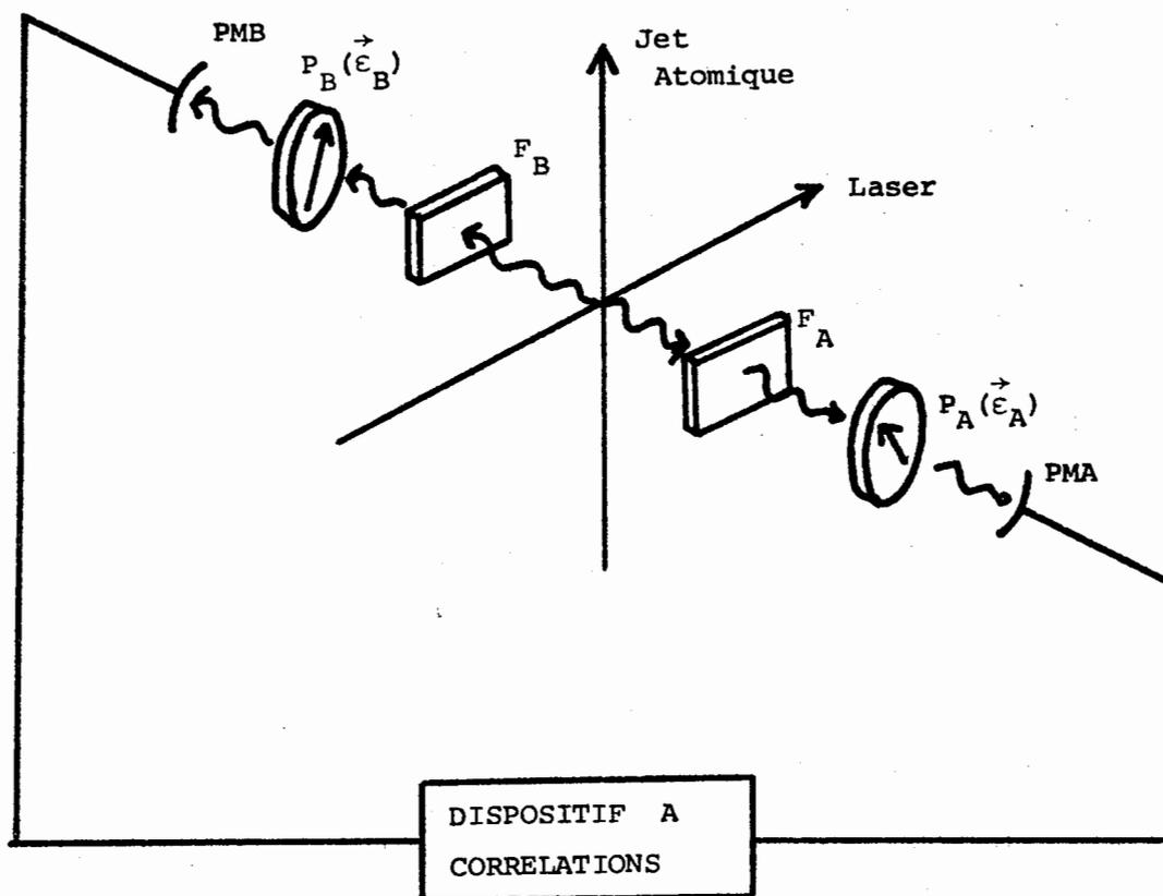
**FIGURE 60** : Schéma expérimental correspondant aux signaux calculés dans le paragraphe III.
