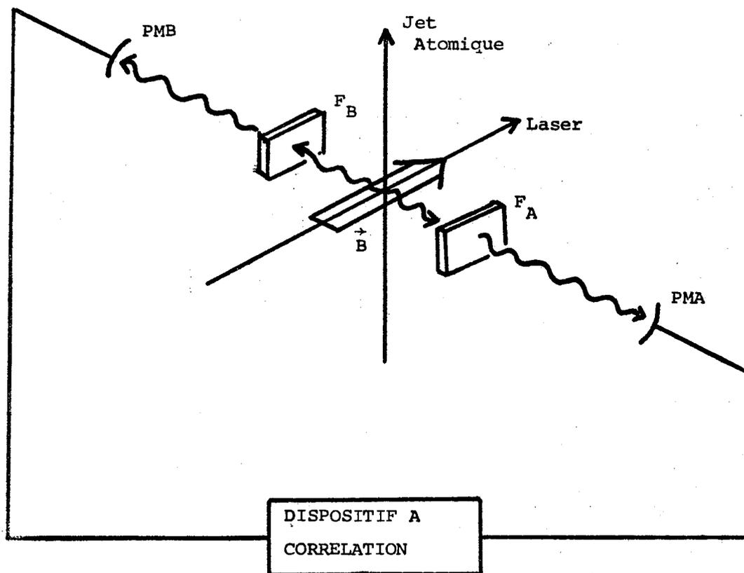
FIGURE 65-a : Configuration expérimentale correspondant au cas  $\vec{\epsilon}_B = \vec{\epsilon}_L$ .
