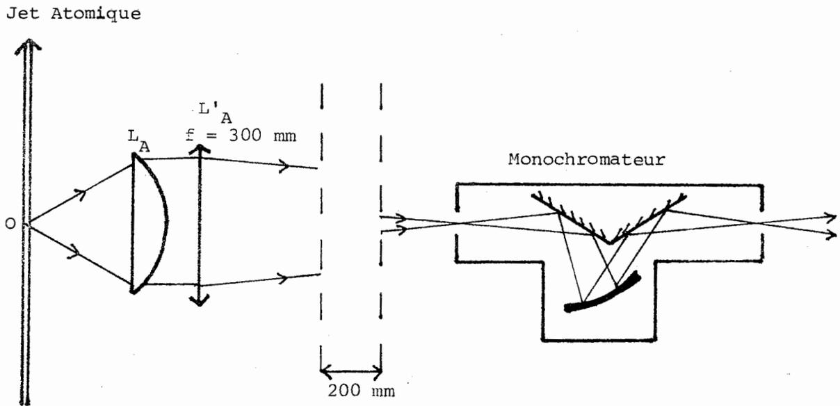
FIGURE 38 : Voie de détection A comportant le monochromateur.
