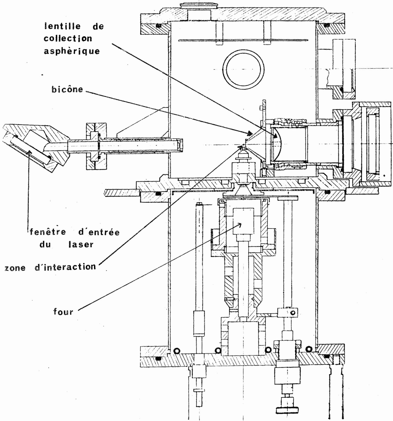
fig 32 : Plan de l'enceinte à vide (échelle 1/3)
