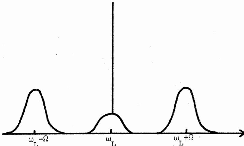
FIGURE 3 : Forme générale du spectre de fluorescence.
