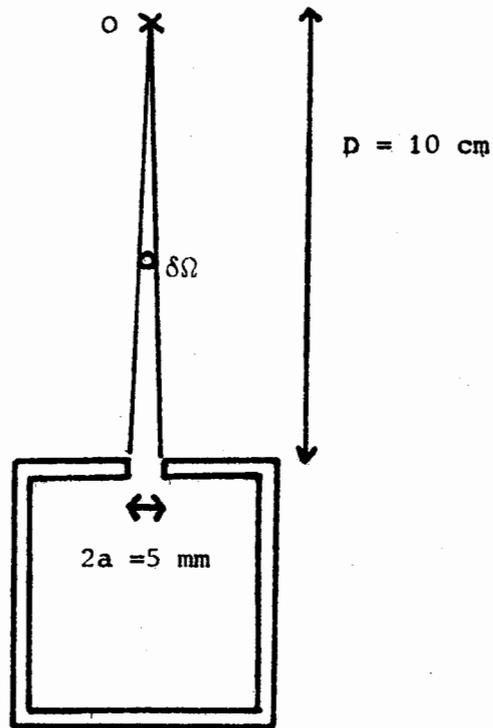
FIGURE 33 : Schéma simplifié du four à Strontium.
