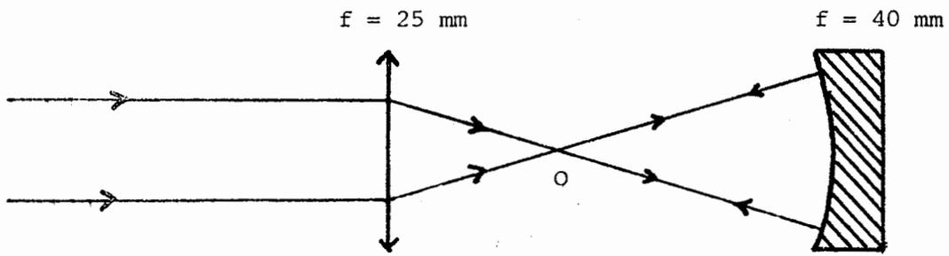
FIGURE 35 : Focalisation du faisceau laser au point 0.
