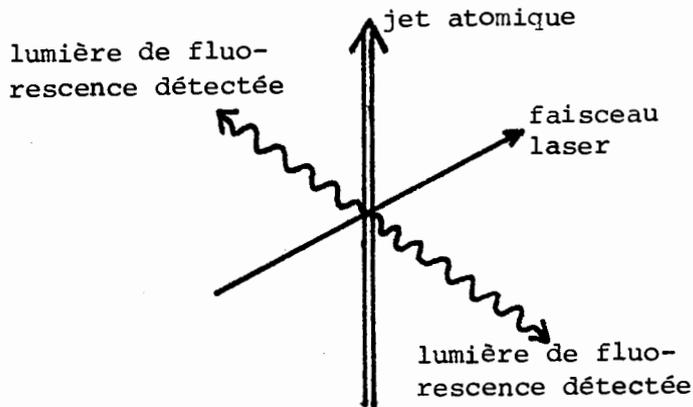
FIGURE 2a: Jet atomique irradié à angle droit par un faisceau laser. Observation de la lumière de fluorescence dans la troisième direction perpendiculaire.
