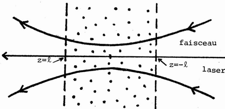
FIGURE 68 : Représentation de la zone d'interaction laser-jet atomique.
