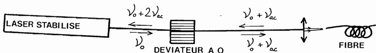
Figure 82 : isolation acoustooptique
