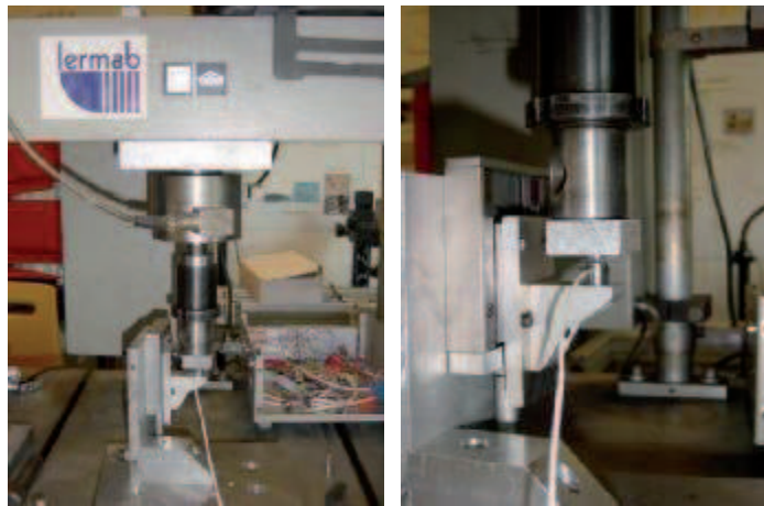
Figure 2.22 : Calibration des capteurs de force sous une machine de compression
