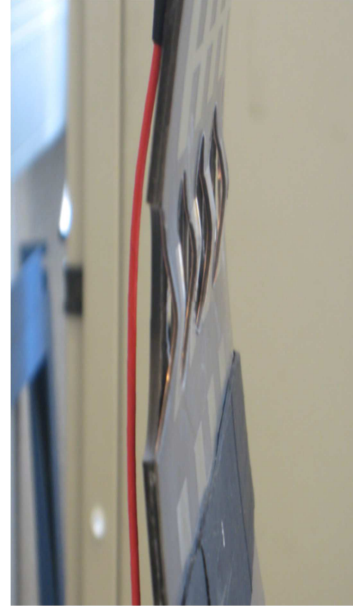
Figure 2.23 : Endommagement de la lame 2: décollement du réseau d'antenne
