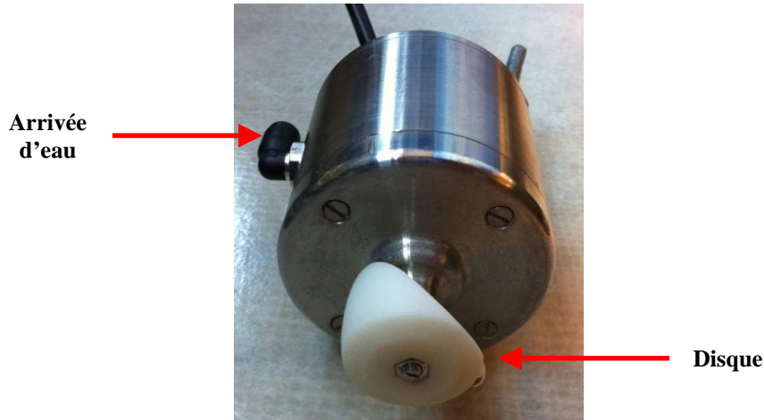
Figure 66 : Photographie de la tête d'aspersion du simulateur de pluie à disque tournant
