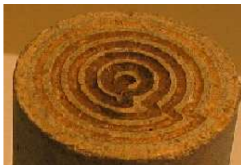
Figure 1.12 – Effets de bord générés par l'altération chimique sur les échantillons de la zone de transition (Bemer et Lombard, 2009)
