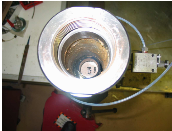
Figure 2.6 – Mise en place de l'échantillon dans la cellule Hassler
