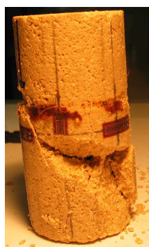
Figure 2.14 – Rupture ductile d'un échantillon testé à 16 MPa de pression de confinement effective
