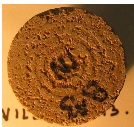
Figure 3.12 – État de surface de l'échantillon de calcaire d'Euville B13 après altération chimique
