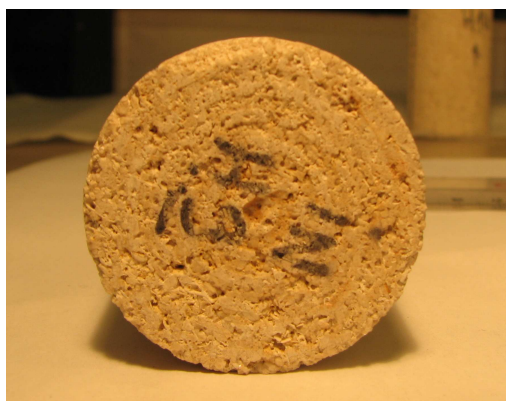
Figure 2.1 – Exemple d'état de surface d'un échantillon d'Euville après altération chimique
