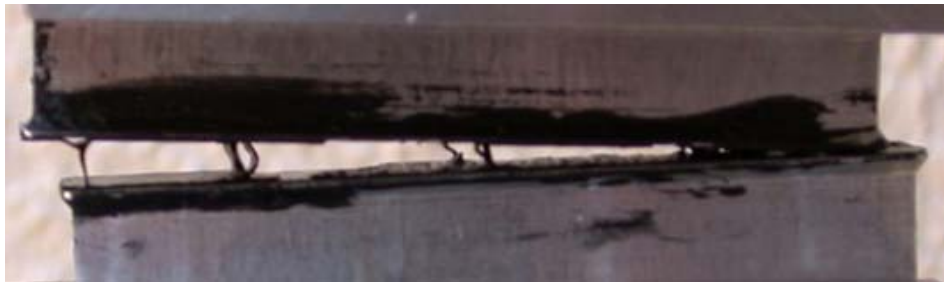
Figure 2.57 Rupture d'une éprouvette en traction plane - colle FMV
