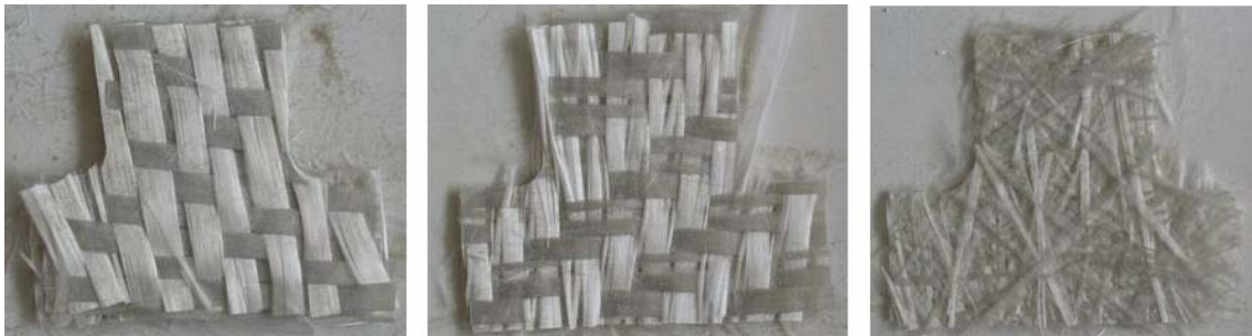
Figure 2.11 Tissage des plis composant le stratifié après pyrolyse : satin de 4, sergé de 2, mat
