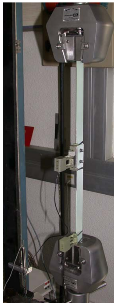
Figure 5.3 A : extensomètre de mesure de la déflexion du joint (TC1), B : extensomètre de mesure de la déformation du substrat près du mors (TC4), C : LVDT de mesure du déplacement de la traverse
