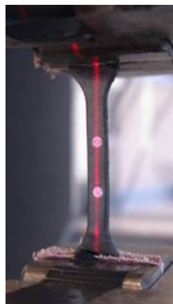
Figure 2.6 Eprouvette massive ISO-37:2005 type 2 et faisceau laser de mesure de la déformation
