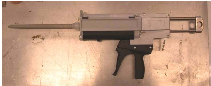
Figure 9.2 Pistolet mélangeur bicomposant pour cartouches de 400 ml, buse hélicoïdale
