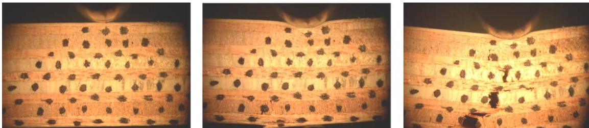
Figure 2.36 Tranche de l'éprouvette lors des essais de flexion trois points sur bois
