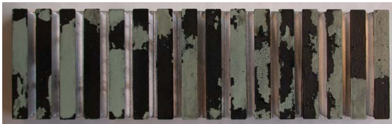
Figure 2.56 Faciès de rupture des essais à 300 \mu\text{m} –en sombre, la colle FMV, en clair, le substrat en aluminium peint
