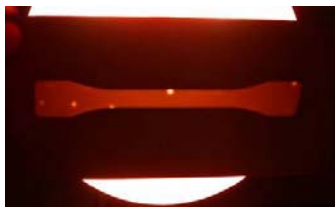
Figure 9.6 Contrôle de la présence de porosités à la lumière d'une lampe
