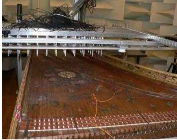
FIGURE 6.1 – Dispositif expérimental d'holographie acoustique en champ proche
