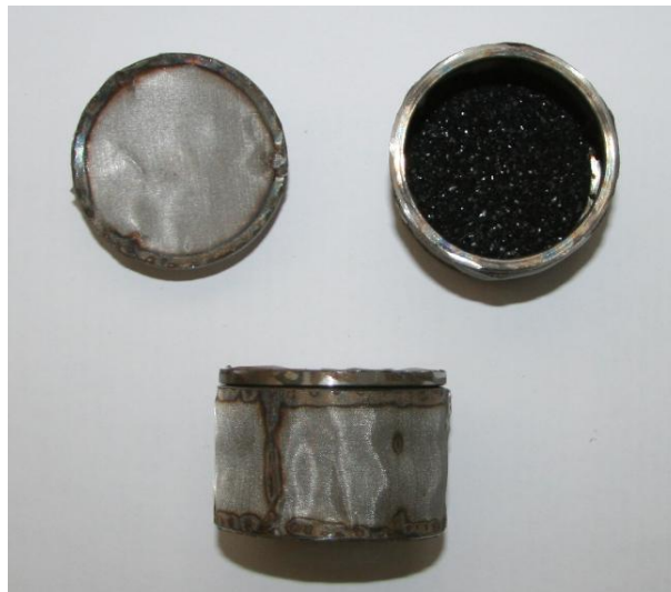
Figure 13 : Corbeille en inox introduite dans la cellule. En haut à droite, un échantillon de charbon broyé à 0,5-1 mm.
