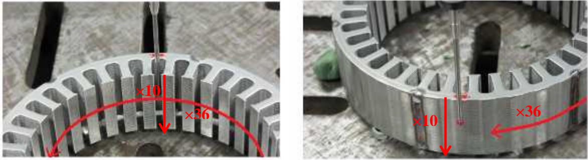
Figure 2.16. Données relatives aux erreurs portées par la culasse (profil interne et externe)
