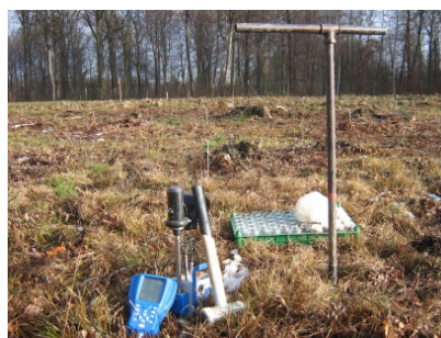
Mesure de la résistance à la pénétration des sols (PANDA®, novembre 2008)
