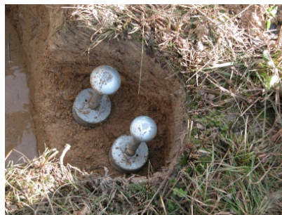
Prélèvement annuel de densité apparente (CA, mai 2009)
