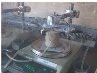
Mesure de la courbe de retrait (laboratoire hépia, Genève, Suisse ; février 2011)
