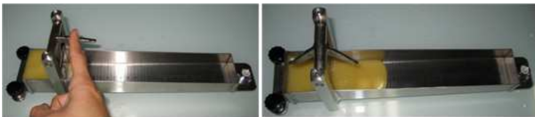
Figure 44. Fonctionnement du consistomètre de Bostwick
