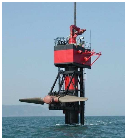
(a) Hydrolienne SeaFlow relevée pour la maintenance [SEAF-05]
