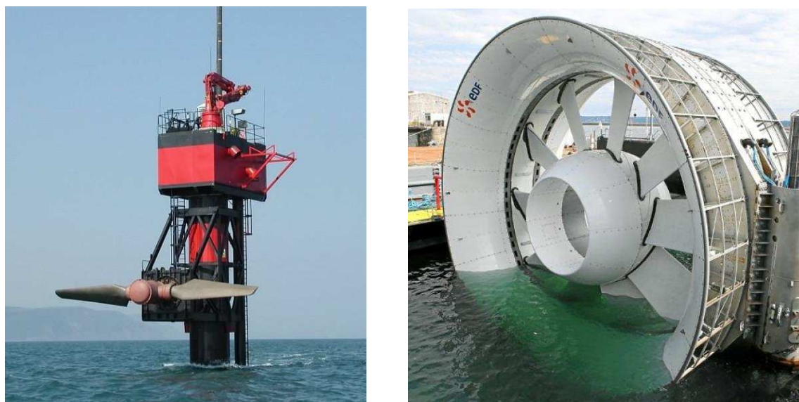
(a) Hydrolienne SeaFlow relevée pour la maintenance [SEAF-05] (b) Hydrolienne à Paimpol Bréhat [ABON-08]
