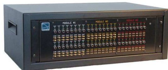
(b) Simulateur Opal-RT : entrées sorties
