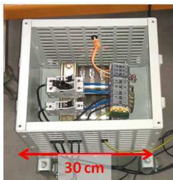
(c) Transformateur monophasé 1000 Hz / 4 kVA / 220-400 V
