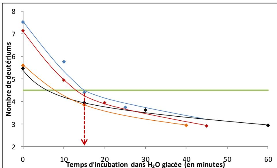
Fig. IV. 18 Nombre de deutériums en fonction du temps d'incubation dans H<sub>2</sub>O glacée. Le débit d'injection a été augmenté à 2,5 µL/min et la sortie de la « cryosource » isolée thermiquement (courbes en bleu et en rouge).
