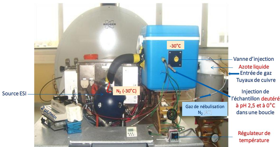
Fig. IV. 7 Photographie de la « cryosource ».
