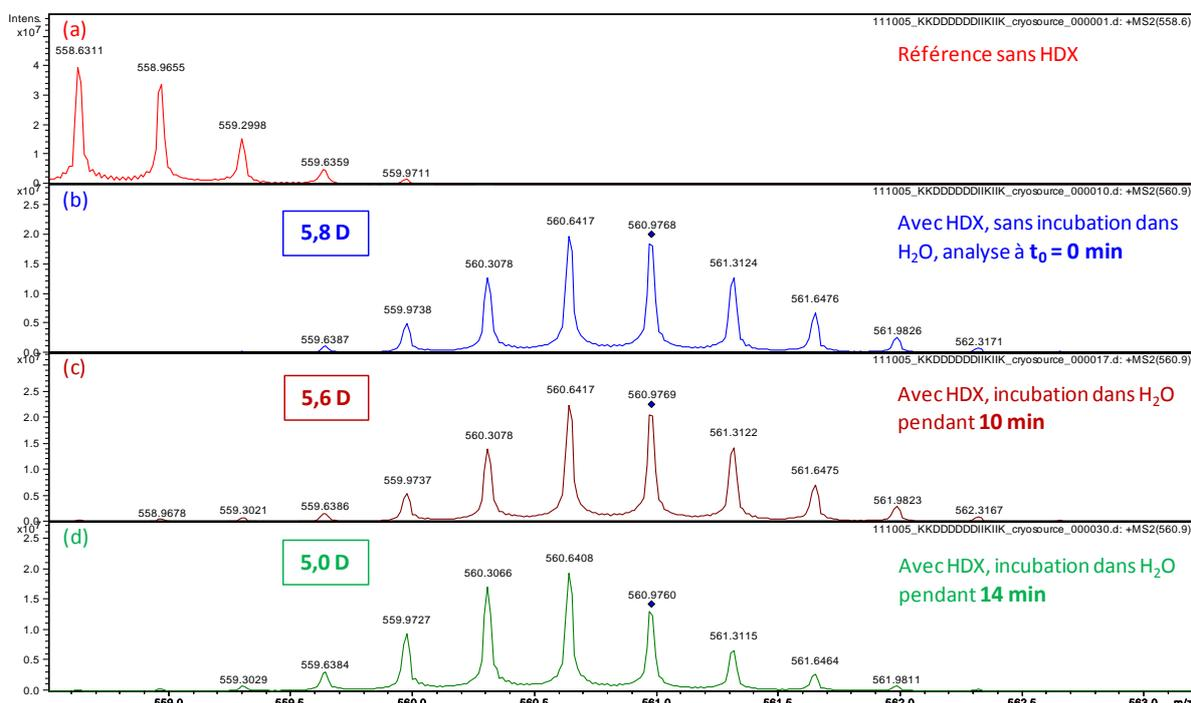
Fig. IV. 15 Zoom du massif isotopique de l'ion parent  $[M+3H]^{3+}$  dans les spectres MS du peptide  $KKDDDDDDIIKIIK$ . Les échantillons marqués sont introduits par la « cryosource » et le nombre de deutériums incorporés est calculé après différents temps d'incubation dans  $H_2O$ ,  $t_0=0$  min (b), 10 min (c) et 14 min (d), par rapport à la référence sans marquage (a).
