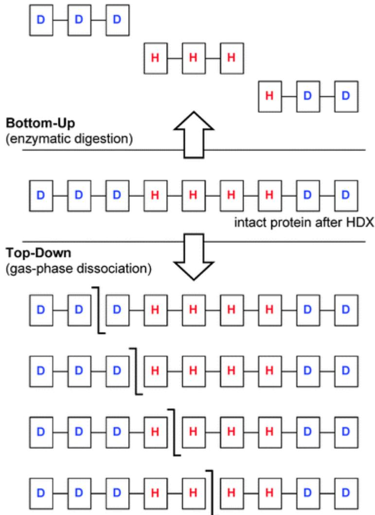
Fig. I. 17 Schéma illustrant la différence conceptuelle entre les approches MS de « bottom-up » et « top-down » appliquées aux études HDX (226). L'approche par fragmentation en phase gazeuse de la protéine entière, dite « top-down », permet de localiser précisément les deutériums dans la séquence protéique.
