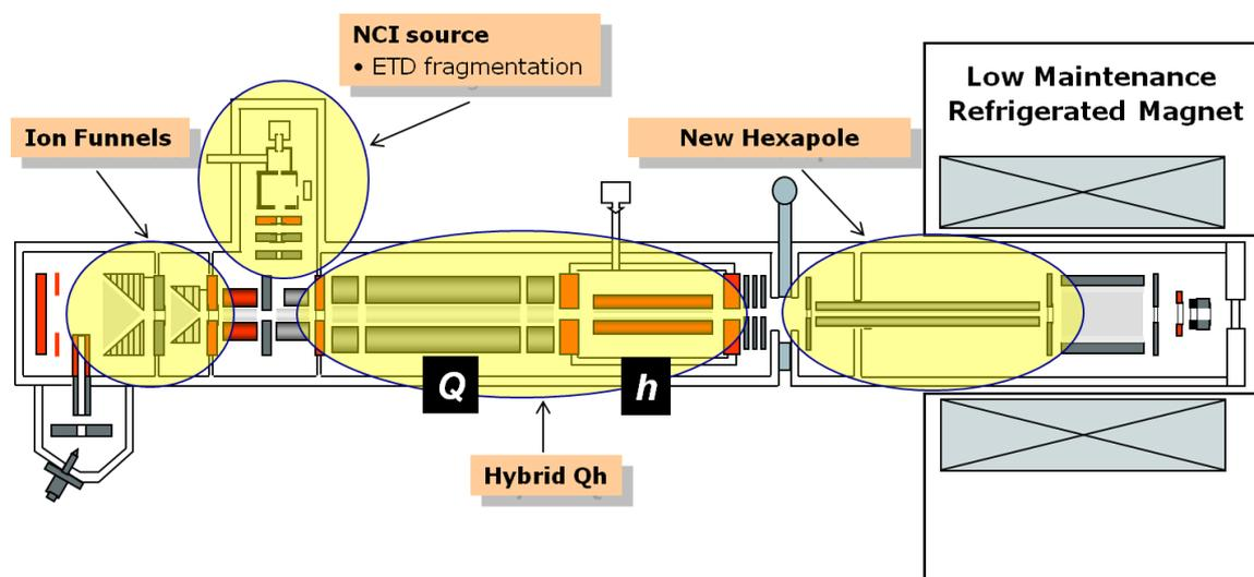
Fig. A. 6 Schéma du FT-ICR Solarix Bruker, de la combi-source à la cellule ICR Infinity Cell (d'après la documentation de Bruker).
