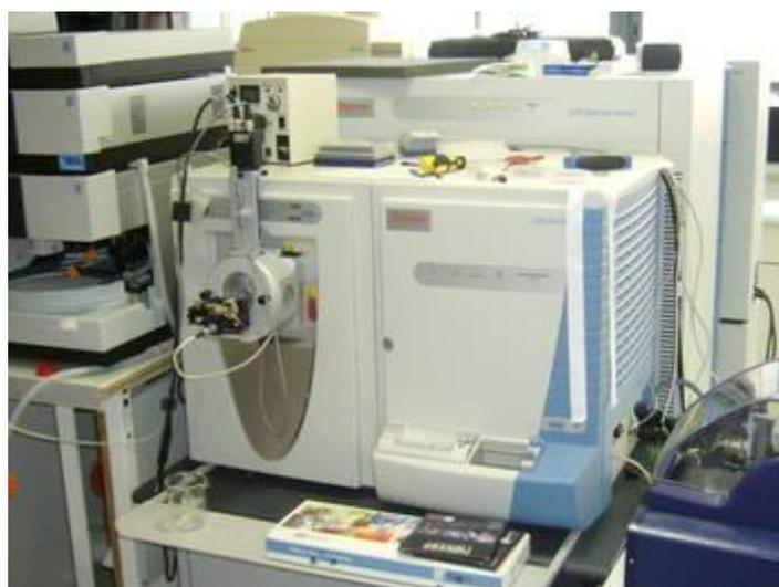
Fig. A. 15 Photographie du spectromètre LTQ-Orbitrap Velos (Thermo Fisher Scientific) de la plateforme protéomique de l'Institut Jacques-Monod (Paris 7).
