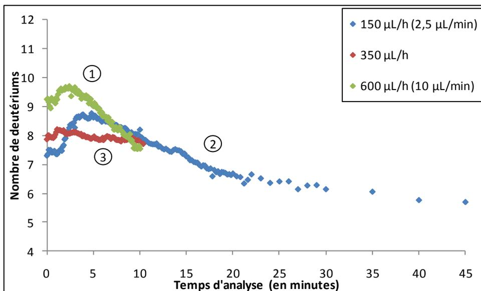
Fig. IV. 26 Nombre de deutériums en fonction du temps d'analyse pour différents débits d'injection sans incubation dans H<sub>2</sub>O glacée. Le débit d'injection de 600 µL/h est testé en premier puis celui de 150 µL/h et enfin celui de 350 µL/h.
