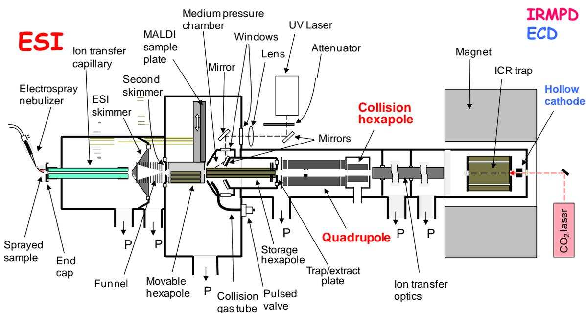
Fig. A. 4 Schéma du FT-ICR APEX-Q Bruker, de la combi-source à la cellule ICR Infinity Cell (d'après la documentation de Bruker).
