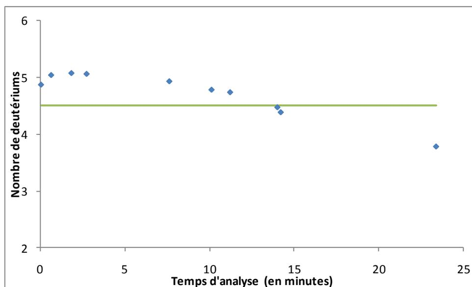
Fig. IV. 16 Nombre de deutériums de l'ion parent  $[M+3H]^{3+}$  du peptide *KKDDDDDDIIKIK* calculé en fonction du temps de résidence dans la seringue refroidie à 0°C tout au long de l'analyse.
