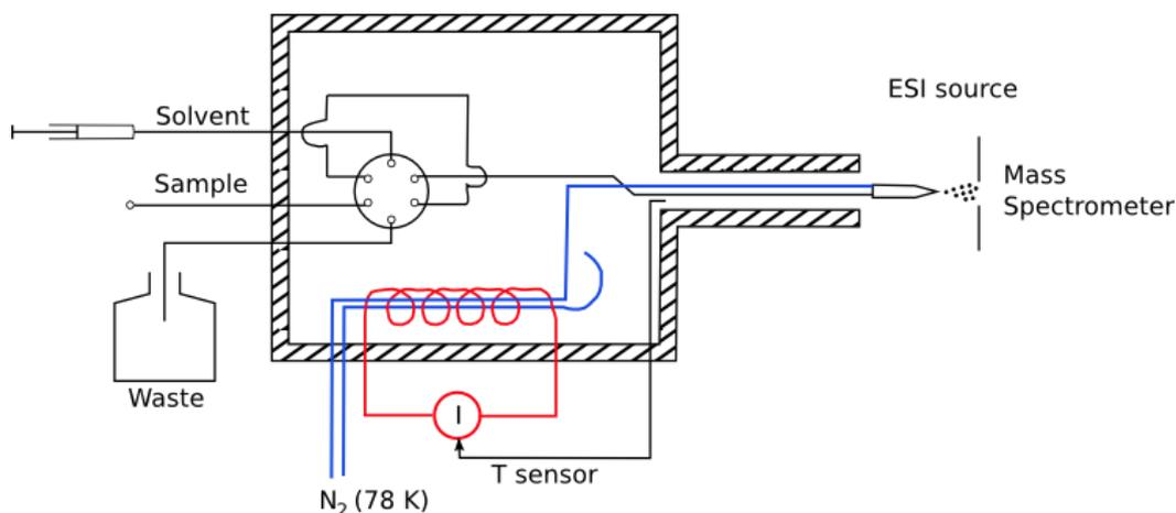
Fig. IV. 8 Schéma du principe de la « cryosource ».
