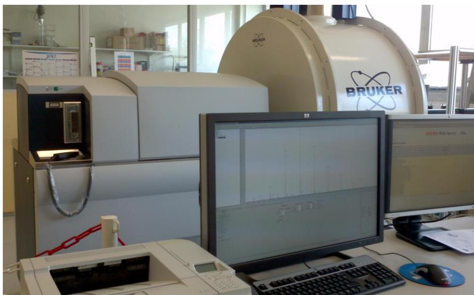
Fig. A. 5 Photographie du FT-ICR Solarix (Bruker).
