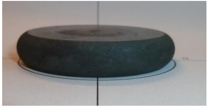
Figure 154 - Vue du lopin après refoulement
