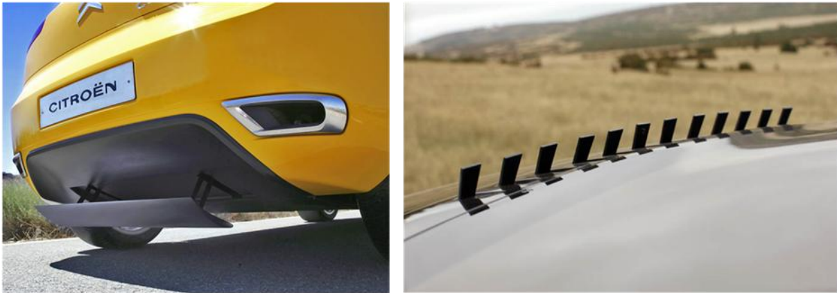
Figure 45 : Contrôle actif chez PSA : aileron déployable sur C-Sportlounge (gauche) et générateurs de vortex escamotable sur C-Airlounge (droite)
