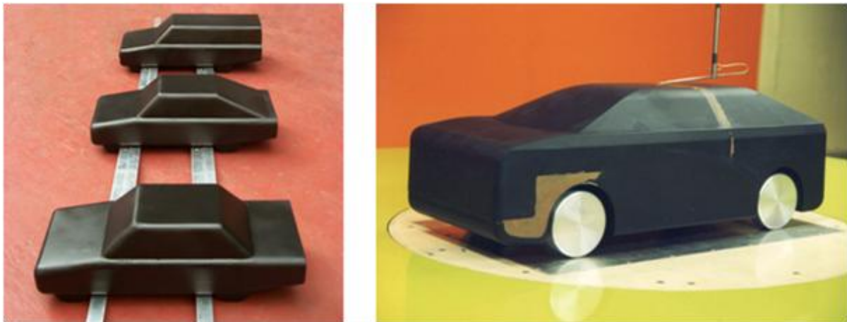
Figure 23 : Corps génériques automobiles : maquettes du MIRA (gauche) et maquette Admunsen (droite, depuis [31])
