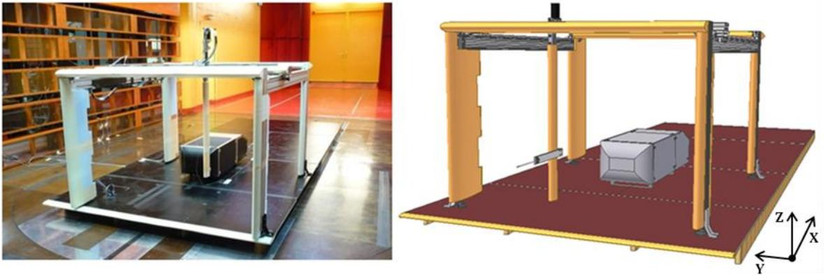
Figure 72 : Explorateur robotisé "2.5D"
