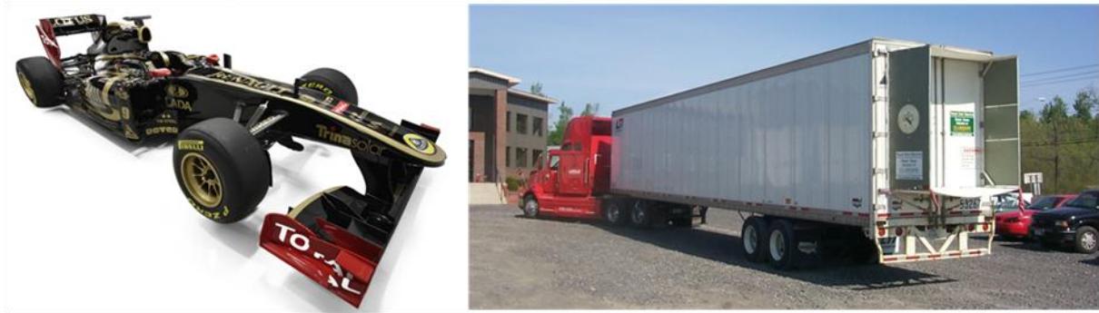
Figure 41 : Appendices aérodynamiques : Lotus Renault R31 2011 (gauche) et plaques séparatrices longitudinales sur un poids lourd (droite, d'après Coon et Visser [64])
