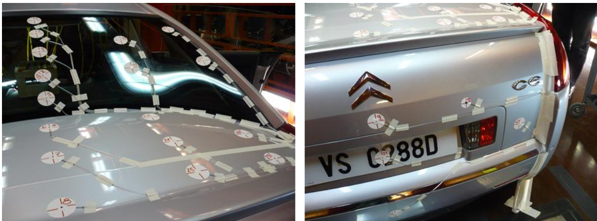
Figure 171 : Implantation des sondes lécheuses sur l'arrière de la C6
