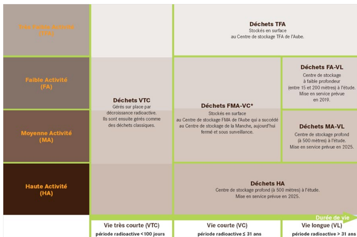
FIGURE 1.2 – Classification des déchets radioactifs français en fonction de leur mode de gestion (ANDRA, Agence Nationale pour la gestion des Déchets RAdioactifs).
