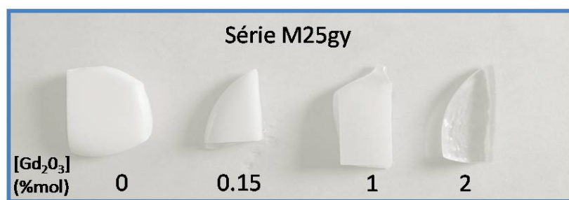
FIGURE 4.5 – Photographies des échantillons de la série M25gy coulés sur plaque. Les échantillons M25g0, M25g015 et M25g1 sont opaques et l'échantillon M25g2 est opalescent.
