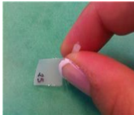
Figure 2.16 : photo d'une micropièce injectée avec la micropresse.
