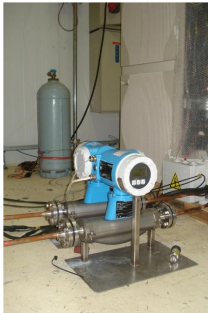
Figure 4.2 - Débitmètres Coriolis utilisés dans les essais de la PAC air/eau
