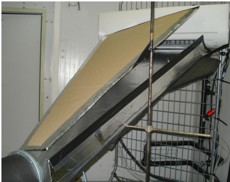
Figure 5.7 - Partie convergente du caisson utilisé dans les essais de la PAC air/air
