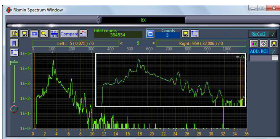
Figure 54 : Spectre PIXE obtenu à partir d'un faisceau de protons de 3 MeV (microsonde nucléaire de Saclay) sur une partie de racine de blé dans le logiciel RISMIN.
