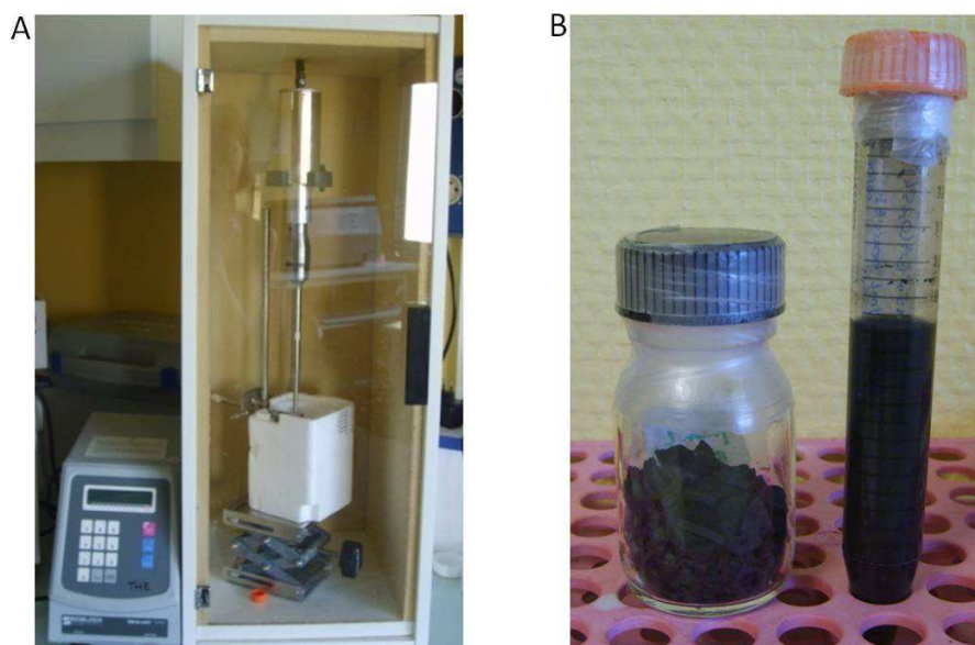
Figure 37 : A. Installation pour la sonification des nanomatériaux : un générateur, un caisson d'insonorisation, la microsonde conique et le bac de réfrigération. B. Présentation des NTC sous forme de tapis (à gauche) puis en suspension (à droite).
