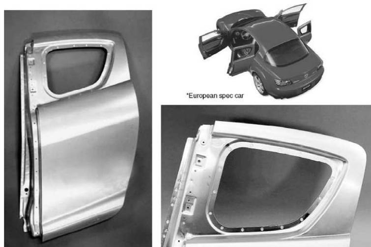
Figure I. 10. Application du soudage par FSW par points [10].
