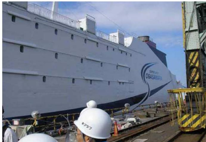
**Figure I. 12. Bateau en aluminium construit en utilisant FSW [12].**
