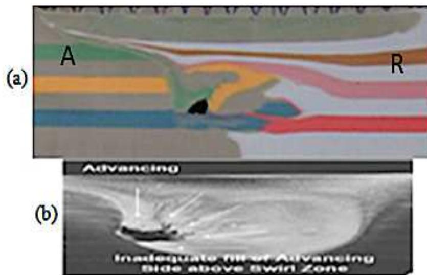
Figure II. 23. Présence des défauts. (a)plasticine ( $N=100\text{tr}/\text{min}$ ,  $V_a=20\text{mm}/\text{min}$ ) (b) essai sur aluminium.
