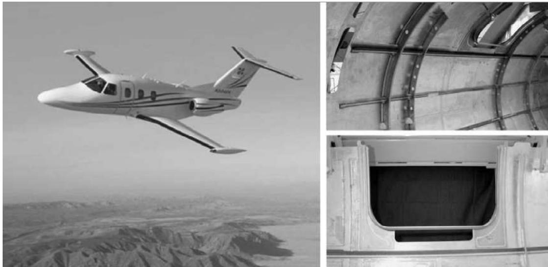
Figure I. 9. Assemblage de l'avion Eclipse 500 avec le procédé de FSW [10].
