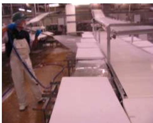
Figure 18 : Nettoyage-Désinfection au canon à mousse d'un tapis convoyeur en PVC
