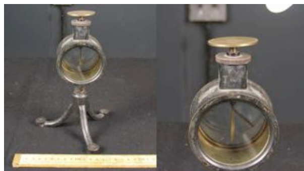
FIGURE 1.2 – Type d'électroscope utilisé par Theodor Wulf pour mesurer le taux d'ionisation de l'atmosphère.
