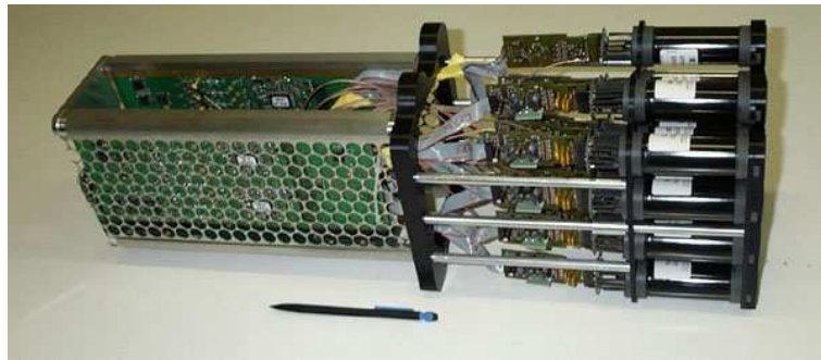
FIGURE 5.21 – Photographie d'un tiroir d'une caméra de H.E.S.S. Les 16 PMTs sont visibles sur la droite et reliés aux cartes électroniques embarquées responsables du déclenchement et de l'acquisition à gauche. Crédit : LPNHE.
