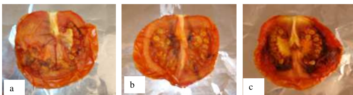
Figure 3.4- Tomates séchées par microondes combinées à l'air chaud ( 40^{\circ}\text{C} ) sans régulation de la puissance spécifique. a : 1 \text{ W/g} ; b : 2 \text{ W/g} et c : 2,5 \text{ W/g} .
