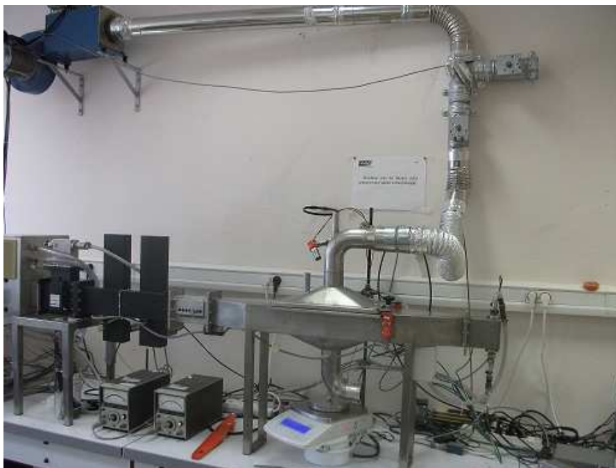
Figure 2.1- Photo du séchoir microondes / air convectif pilote de laboratoire
